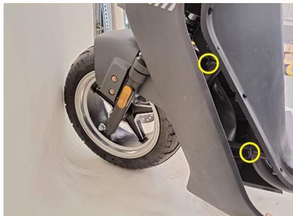
Raota etupaneelia ja irrota sen alta paljastuvat etusisälokasuojan kiinnitysruuvit (ristipäämeisseli ph2).
