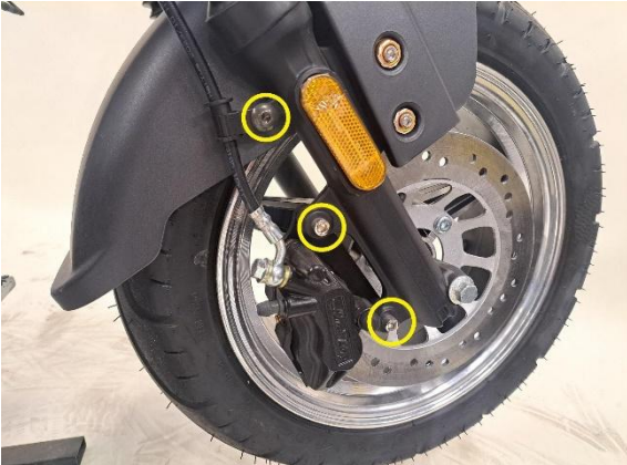
Irrota etujarrusatulan ja etujarruletkun pidikkeen kiinnityspultit (kuusiokoloavain 5 mm).
