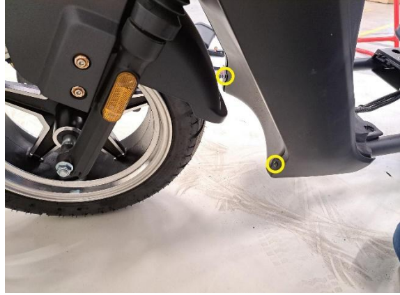
Irrota etusisälokasuojan kiinnitysruuvit (ristipäämeisseli ph2).
