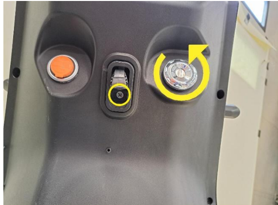
Irrota koukun alta paljastuva kiinnitysruuvi (ristipäämeisseli ph2). Käännä virtalukon kehystä vastapäivään.
