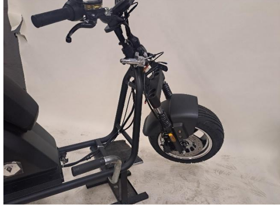
Nosta etupää korokkeen päälle.
