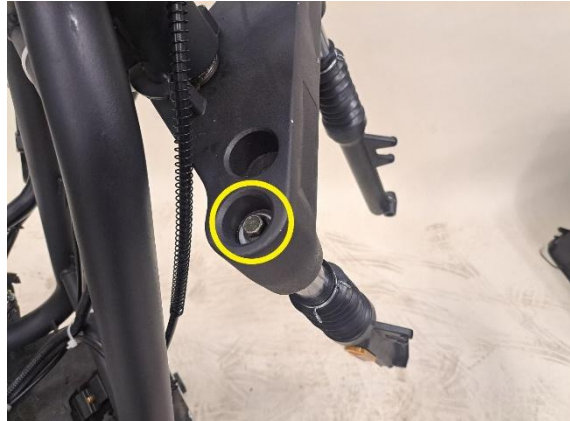
Irrota etujousen kiinnityspultti (hylsy 12 mm).
