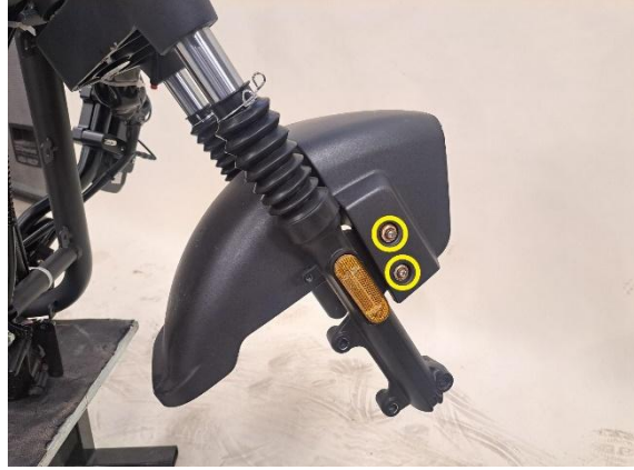
Irrota etulokasuojan kiinnityspultit kummaltakin puolelta (kuusiokoloavain 5 mm).
