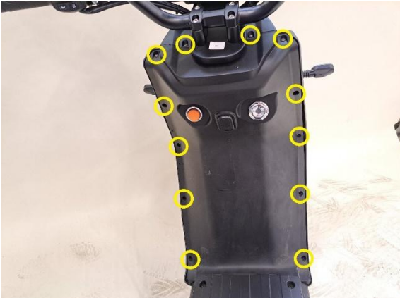
Irrota keula muovin kiinnitysruuvit (ristipäämeisseli ph2).
