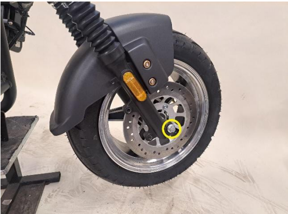
Irrota akselin kiinnitys (kiintoavain 14 mm) vastamutteri (kiintoavain 17 mm).
